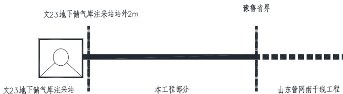
图 2.1-2 本项目管道与山东管网和储气库的工作断面
